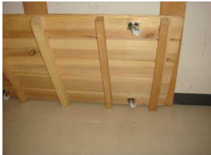
②毒薬を設置するスノコ（物を載せる）は清掃しやすいようにキャスターを付け可動式にする
